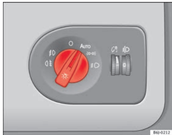
Fig. 55 Encendido automático de luces
