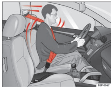
Fig. 10 Conductor con el cinturón de seguridad bien puesto: es sujetado por el mismo en un freno brusco
