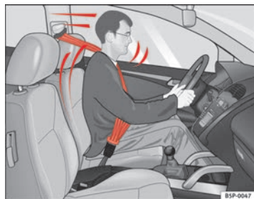
Fig. 10 Conductor con el cinturón de seguridad bien puesto: es sujetado por el mismo en un frenazo brusco
