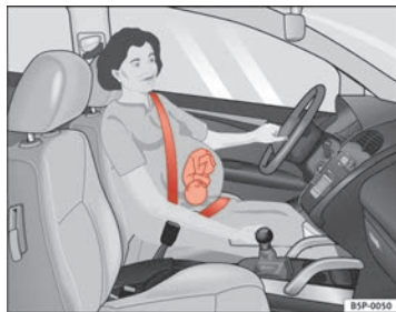
Fig. 14 Colocación de la banda del cinturón en el caso de mujeres embarazadas
